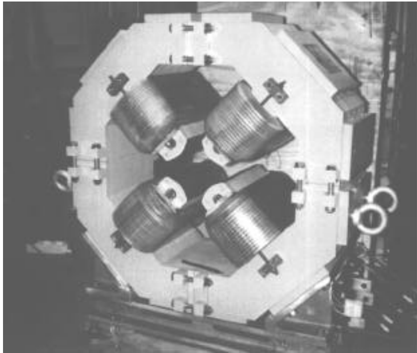
Figura 1 - Quadrupolo prototipo per gli archi dei Main Rings.
